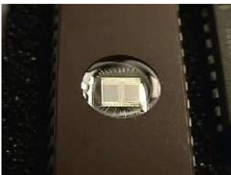
Figura 4. Apariencia Física de una EPROM
