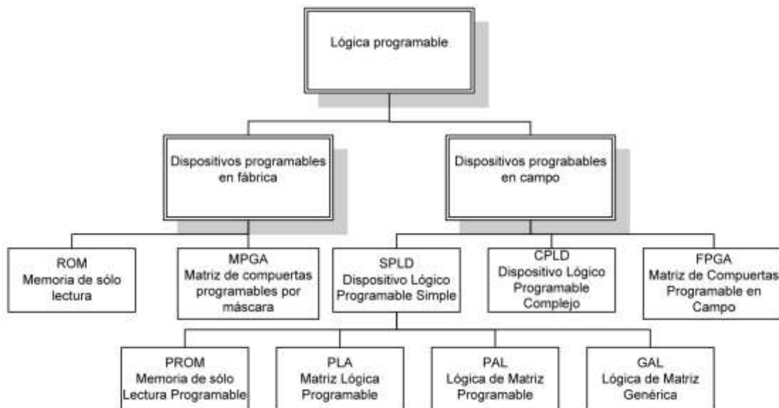
Figura 10. Clasificación de los distintos tipos de dispositivos lógicos programables
